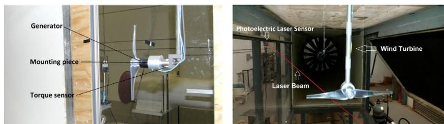
Figura 12 (a) Sensor de par montado en la turbina eólica con el fin de medir la potencia recolectada, (b) Configuración para medir la velocidad angular de la turbina eólica.
