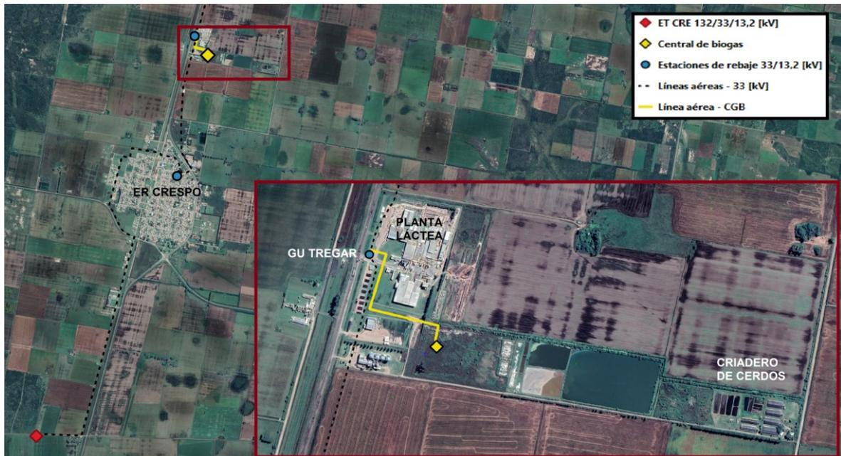
Figura 3 Mapa satelital con el diagrama georreferenciado de la red de 33 kV y la CTB proyectada.
