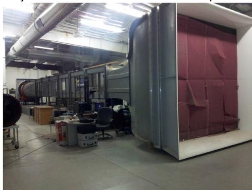
Figura 11 Túnel de viento de baja velocidad utilizado en el ensayo
