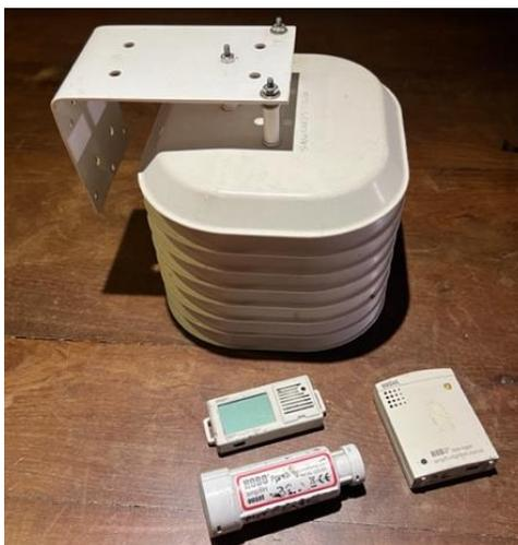
Figura 3: Instrumental utilizado en la monitorización higrotérmica. Fuente: Propia, 2022.
