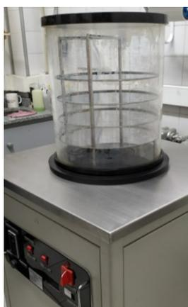
Figura 2 Liofilizador
