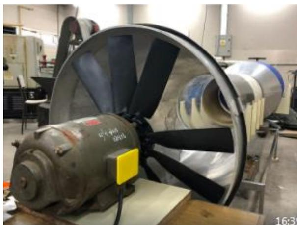
Figura 3: Modelo de Ventilador a usar en el túnel de viento.
