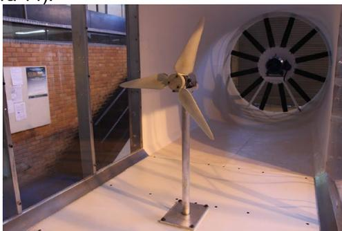
Figura 14 La turbina a escala 1:20 dentro de la sección de prueba del Túnel de viento del Laboratorio de Energía y Medio Ambiente, de la Universidad de Brasilia
