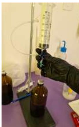
**Figura 2.** Sistema de extracción del biogás.
