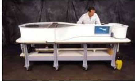
Figura 2 *Túnel de agua (Water Tunnel)*
