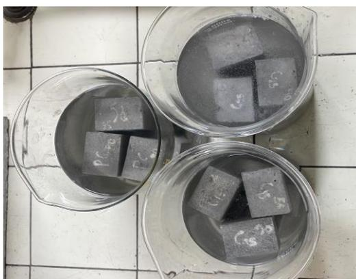
Figura 5. Barras de mortero fraccionadas
