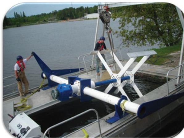
Figura 11 Un Darrieus HKT de eje vertical de New Energy Corp de 25 kW en Canadá, levantado del agua [1]
