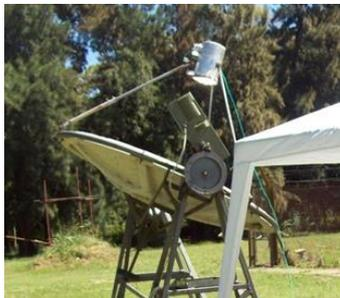
Figura 7 Disposición de calorímetro y disco parabólico
