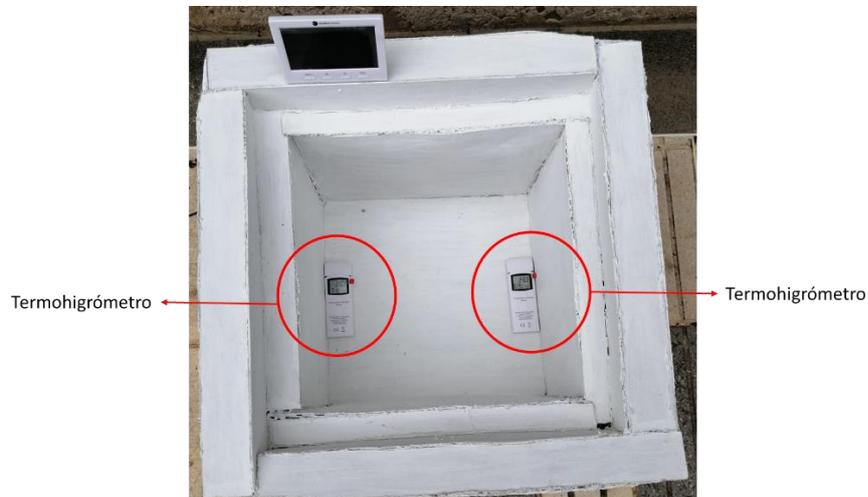
Figura 4 Implantación de sensores para monitorización de variables del interior
