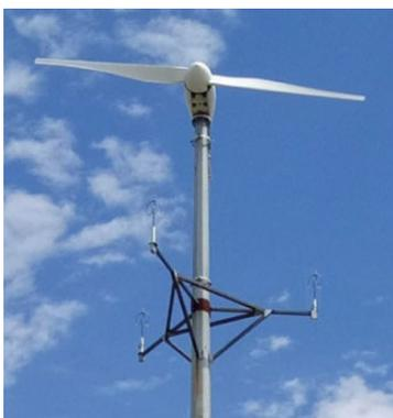
Figura 4 Descripción general de la turbina Aerogenesis de 5 kW [11]
