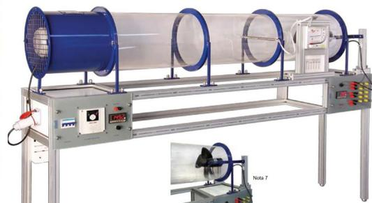
Figura 5a *Túnel de humo de retorno abierto subsónico (subsonic open return smoke tunnel)* y 5b *Túnel de retorno abierto existente en el GESE FRBB*
