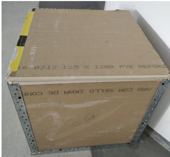
Figura 6: Caja térmica del dispositivo para aislar el ensayo del ambiente circundante y disminuir las pérdidas de calor. Fuente: elaboración propia.
