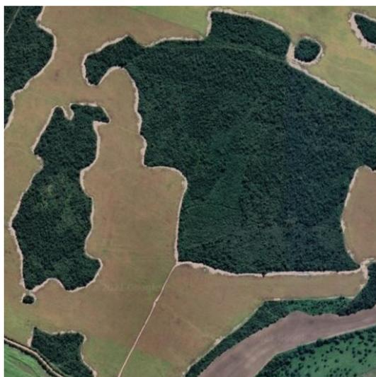
Se aplica la transformada de wavelet para identificar zonas, la zona de bosques (o plantación pesada). Esta detección se logra analizando las texturas de las diferentes zonas presentes en una imagen y filtrando a partir de los coeficientes wavelet.
