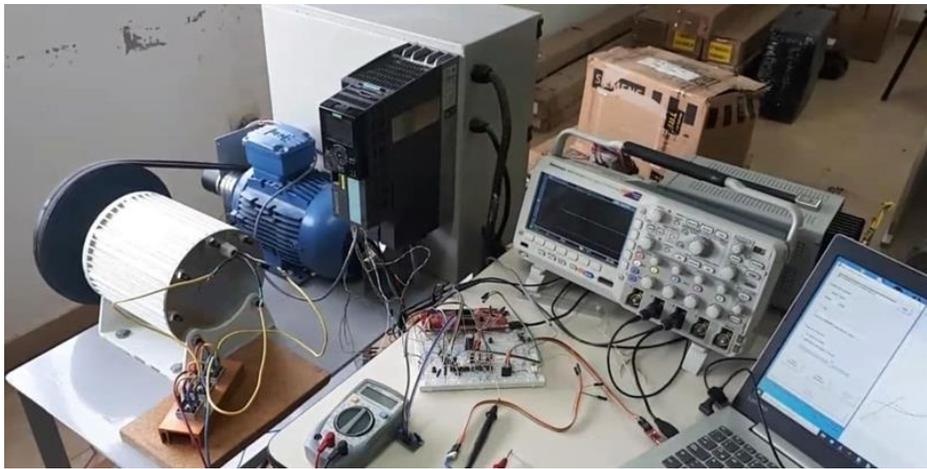
Figura 5. Prototipo experimental del emulador propuesto de turbina eólica de baja potencia
